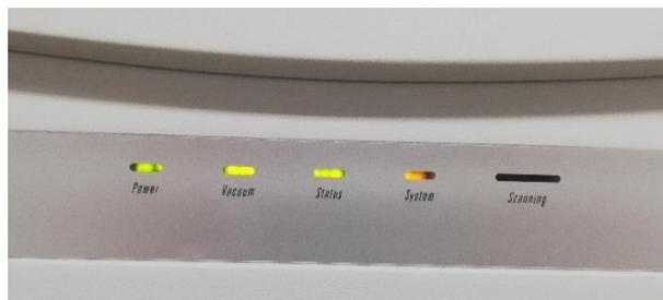
Figura 3 Luces indicadoras de estado del Q Exactive
