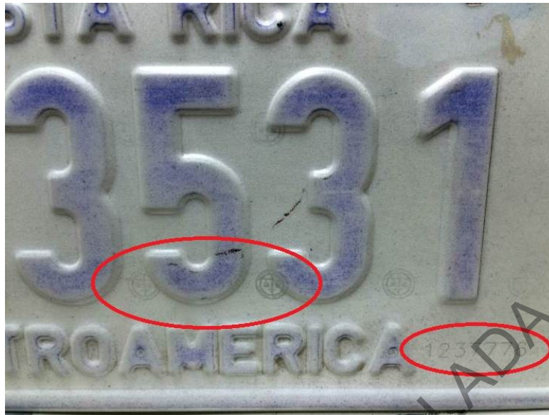
Figura N°7: Medidas de seguridad en la emisión 5: consecutivo y logos RN.
