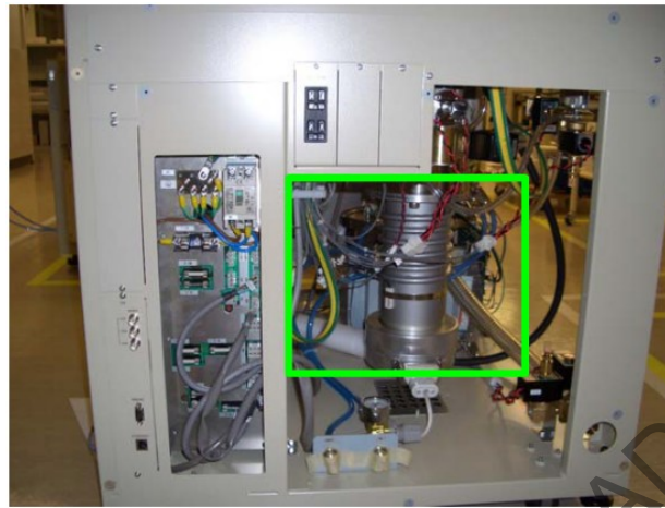
Figura 11. Vista lateral del SEM sin la respectiva tapa donde se puede apreciar la bomba difusora.
