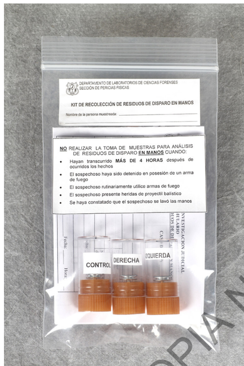
Figura 1. Kit para la recolección de muestras mediante cinta adhesiva de carbón para análisis de residuos de disparo mediante SEM-EDX.
