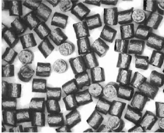
*Figura 5-A03. Pólvora con morfología tubular corta con perforación visible*
