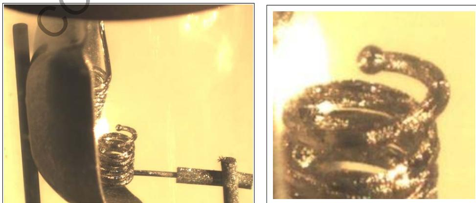
En algunas ocasiones cuando el filamento se encuentra envejecido, es posible observar -a pesar de una leve deformación en el filamento- la presencia de desprendimientos de partículas de material de tungsteno perteneciente al filamento que se encontraba
