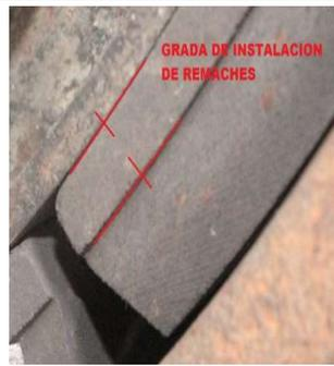
*En rojo se observa la grada de instalación de remaches*
