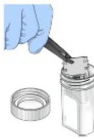
Figura 12. Celda de flujo en el contenedor con líquido.
