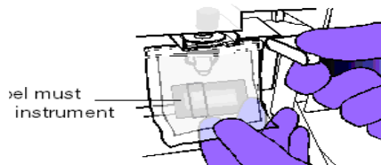
Figura 18. Inserción del reactivo acondicionador en el mecanismo de la bomba.
