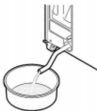
Figura 20. Detalle del drenaje del agua del interior del tanque del equipo Panasonic Labo Autoclave MLS-3781L.
