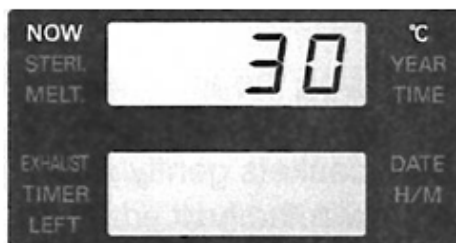
Figura 8. Imagen de ejemplo de la medición de la temperatura dentro del tanque con la tapa abierta.
