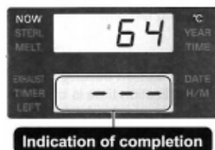
Figura 13. Imagen de la pantalla digital del panel de control, al momento de finalizar el proceso de esterilizado.
