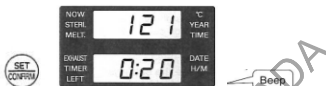
Figura 12. Imagen de ejemplo de la modificación de la configuración de la esterilización del equipo Panasonic Labo Autoclave MLS-3781L
