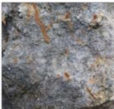
**Fig. 17.** Las concentraciones redox se observan en color anaranjado en el suelo arenoso (US. Army Corps of Engineers et al, 2011).
