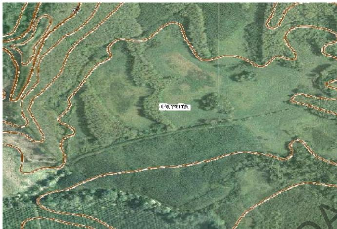
**Fig. 43.** Imagen ejemplo de las curvas de nivel, tomado de [www.snitcr.go.cr](http://www.snitcr.go.cr).
