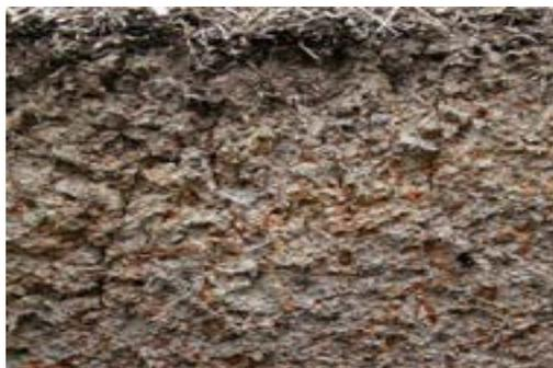
**Fig. 19.** Imagen ejemplo de una matriz agotada, donde las concentraciones redox se extienden cerca de la superficie del suelo (US. Army Corps of Engineers et al, 2011).
