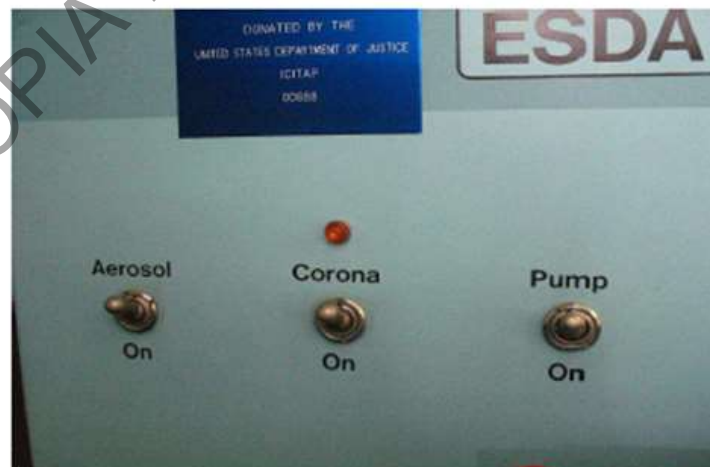
Interruptores del equipo ESDA.
