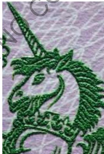
**Figura 33:** Calcografía vista con luz rasante
