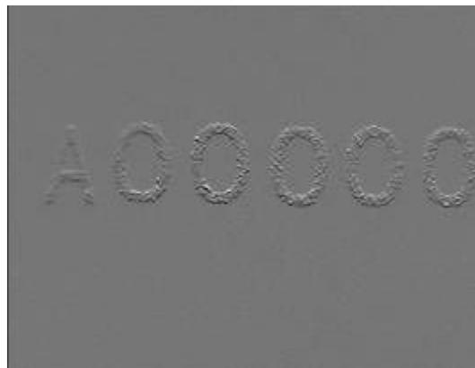
**Figura 51:** Caracteres magnéticos recuperados mediante lector magnético, visible en billete de 20 000 colones, serie A 2009 del Banco Central de Costa Rica.
