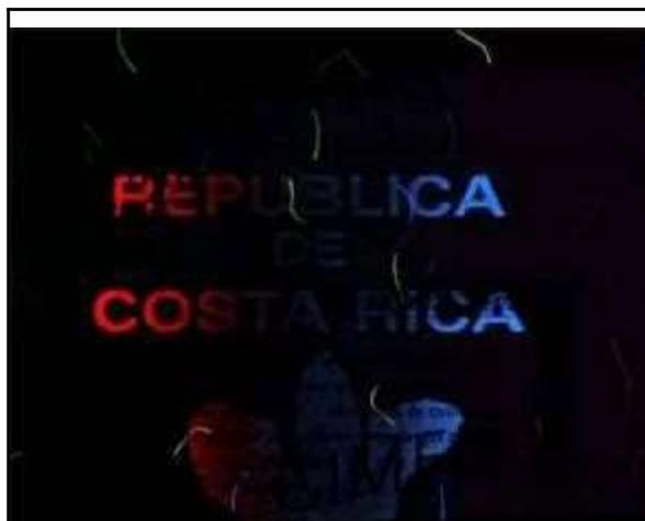
**Figura 4:** Fibrillas de Seguridad visible con luz ultravioleta en pasaporte de Costa Rica.
